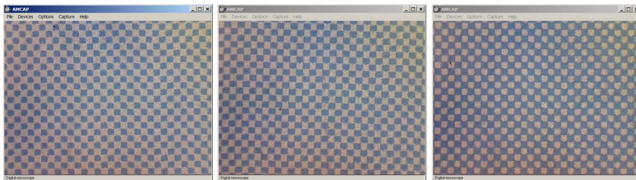
Surface tramé géométrique < 50 %    Surface tramé géométrique ~ 50 % (pts de trame ronds)    Surface tramé géométrique > 50 %
