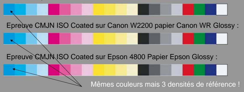
Contrôle colorimétrique de l'imprimante d'épreuves possible : Exemple Gamme Fogra MediaWedge 2
