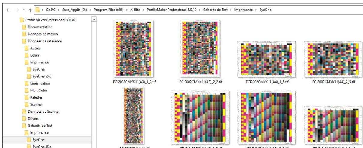
**Le sous-répertoire Gabarits de Test** : Contient des mires destinées à être mesurées à l'aide des **i1Pro** ou **i1Pro 2** (et d'autres instruments de mesure X-Rite), classées en tant que mires **Imprimante**, mires de **Linéarisation** et mires **Multicolor**.
