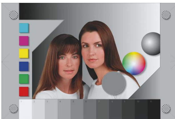
Image CMJN ISO Coated_v2 en mode saturation avec profil I.C.C. recalculé avec i1Profiler ou ProfileMaker
